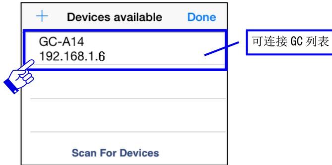
4) 点击可连接 GC 列表中的“GC-A14 192.168.1.6”，输入账户密码后，连接到 GC，并显示 GC 当前画面。
