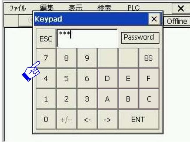
输入密码后，按 [ENT] 键确认。如果密码不匹配，会删除输入的密码。
