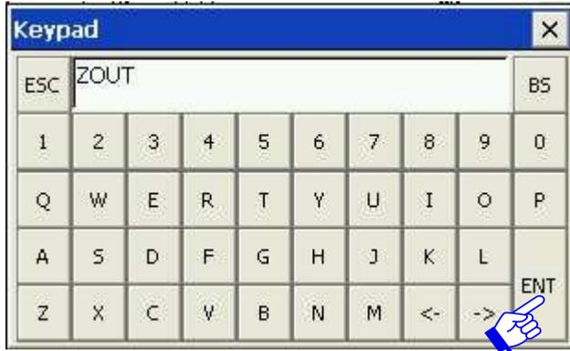
点击[编辑]按钮，打开键盘，直接输入要搜索的指令/要素，并点击[ENT]确认。
